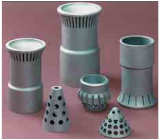
Feingegossene Brennerköpfe und Katalysatorroste aus GX25CrNiSi20-14
