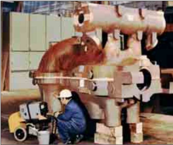
Bild 47: Ultraschallprüfung an einem Dampfturbinenzylinder aus warmfestem Stahlguss in Gussverbundkonstruktion
