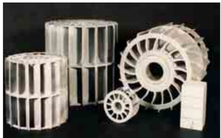
Bild 83: Laufblätter aus verschiedenen austenitischen Stahlgussorten für Flüssigkeitspumpen im Massebereich von 40 bis 830 kg
