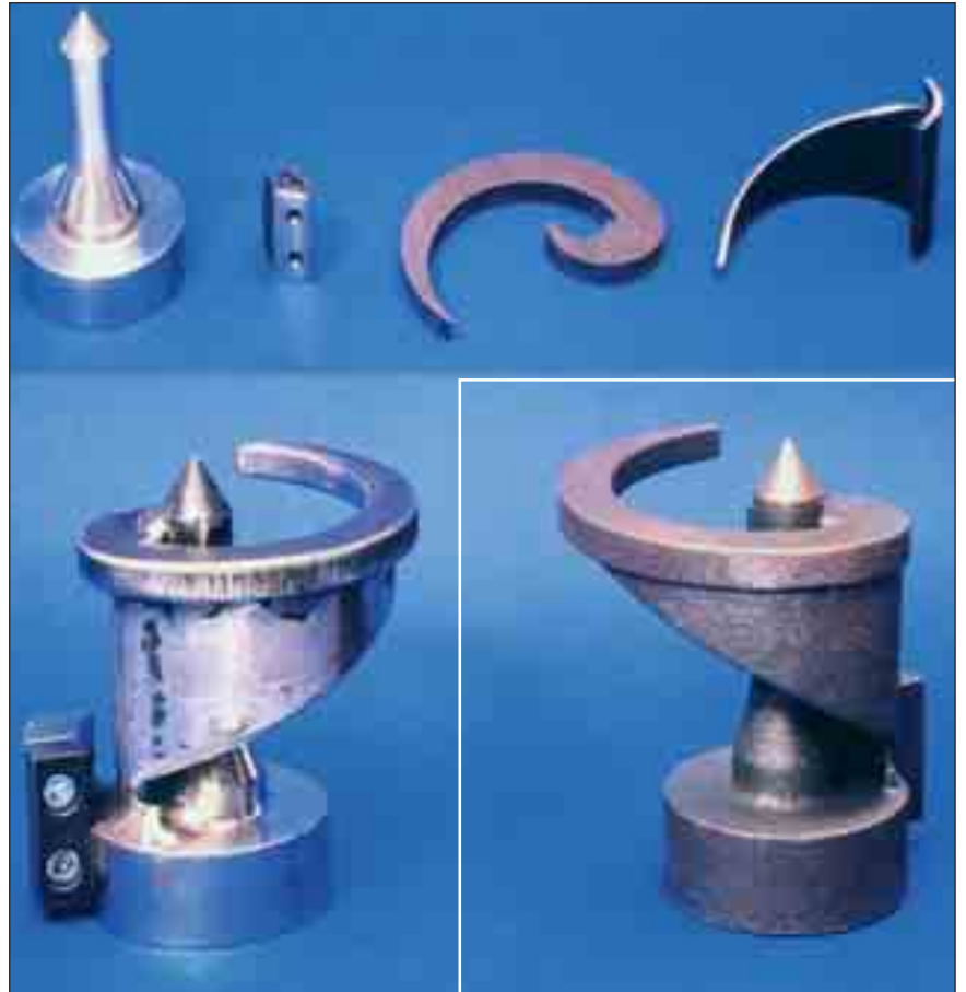
Drillhaken für eine Verpackungsmaschine aus Vergütungsstahlguss G42CrMo4, Masse 1,6 kg; Abmessungen 20 x 120 x 120 mm, 4 bis 25 mm Wanddicke. Das im Lost-Foam-Verfahren hergestellte einteilige Gussteil (Bild unten rechts) ersetzt eine Schweißkonstruktion (Bild unten links) aus vier Füge-teilen (Bild oben) unter Einsparung von Montageaufwand und einem Großteil der Bearbeitung.
