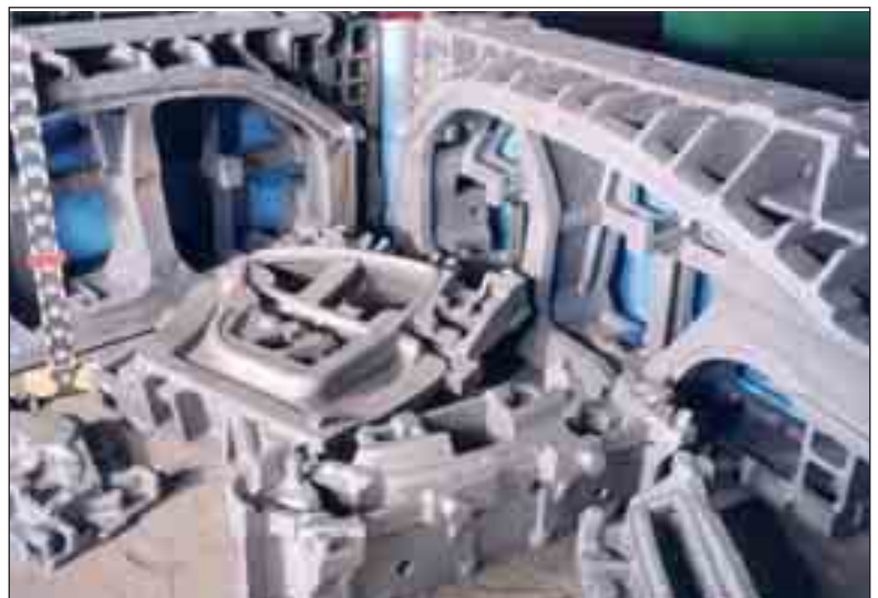
Blechumformwerkzeugussteile aus verschiedenen hoch verschleißbeständigen Stahlgussorten für den Automobilbau im Massebereich von 100 bis 5000 kg
