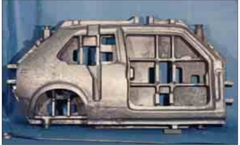
Prägewerkzeug für ein Pkw-Seitenteil aus G45CrNiMo4-2, Masse 8 t, Abmessungen 3,0 x 1,8 x 0,8 m
