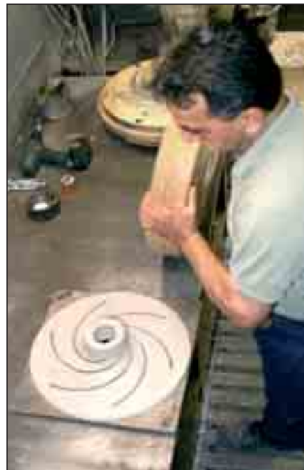
Bild 4: Fertigung von Keramikgießform und Kernen für das Bauteil „Produktverteiler“ aus Duplexstahlguss GX2CrNiMoN22-5.
