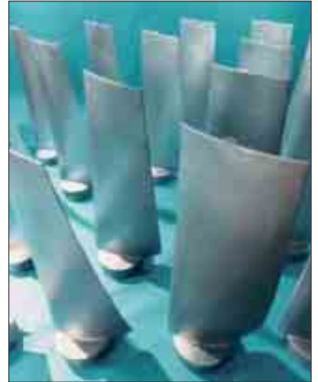
Lüfterschaufeln aus Feinguss, Werkstoff: NiCr23Mo16 DI, Stückmasse 85 kg
