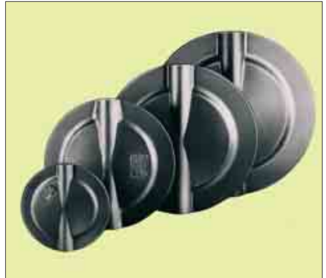
Bild 88: Hohlgegossene Scheiben für REA-Absperrklappen der Größen DN 500 bis DN 1200 aus dem Werkstoff GNiMoCr16-15W
