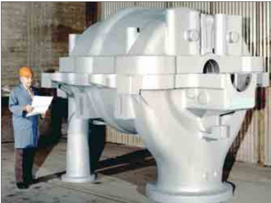
Bild 73: Verdichtergehäuse aus niedriglegiertem, kaltzähem NiMo-Stahlguss der Abmessungen 3,6 x 2,7 x 1,6 m; Masse 18,6 t nach ASTM A 352 LC2
