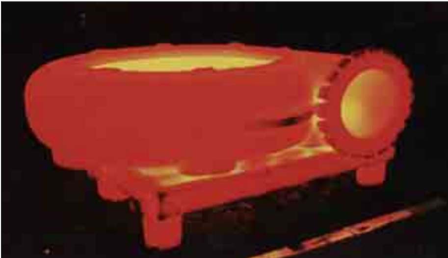
Bild 43: Die Wärmebehandlung ist ein entscheidender Abschnitt bei der Herstellung von Stahlguss. Ein gesteuertes Abkühlen nach dem Glühen sichert die gewünschte Gefügeausbildung und damit die Werkstoffeigenschaften dieser Stahlgussteile
