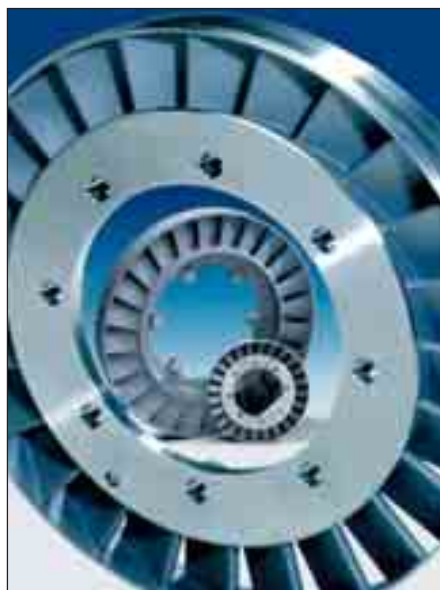
Bild 21: Düsenringe für Turbolader aus hitzebeständigem Stahlguss GXCrNiSi26-10-5 mit einem Radius von 0,5 mm an den Schaufeleintrittskanten
