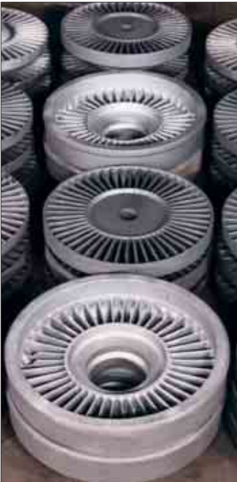
Primär- und Sekundärräder aus Vergütungsstahl für hydrodynamische Kupplungen, Abmessungen Dmr. 680 mm
