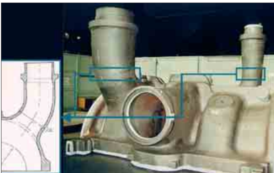
Bild 69: Innengehäuse für die Mitteldruckstufe einer Turbine mit angeschweißten Krümmern aus GX12CrMoWVNb10-1-1
