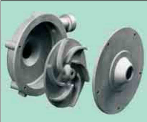
Gehäuse, Laufrad und Deckel einer Spiralpumpe aus korrosionsbeständigem Edelstahl (GX5CrNiMoNb19-11-2)
