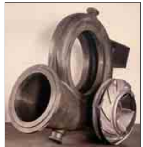
Bild 79: Gehäuse und Laufrad für die Pumpe einer Rauchgas-Entschwefelungsanlage aus dem Werkstoff GX40CrNiMo27-5
