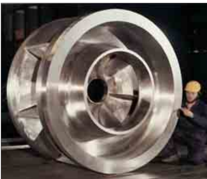
Bild 85: Sauggehäuse für eine Kernkraftwerkspumpe aus GX6CrNi18-9 der Abmessungen Dmr. 1880 x 860 mm; Masse 4050 kg
