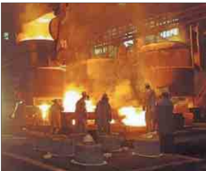
Bild 9: Abguss eines großen Stahlgussteils mit mehreren Pfannen
