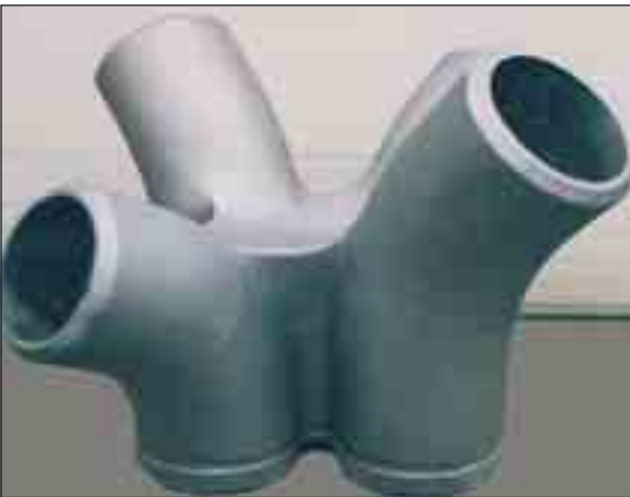
Gussknoten aus G20Mn5 N für die Stahlkonstruktion in baumähnlicher Bionikausführung am Stuttgarter Flughafen; diese 2,3 t schweren Gussteile bilden die Grundebene, die die gesamte Stahlkonstruktion hält
