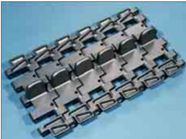
Bild 95: Kettenglieder für ein Kettenfahrzeug aus dem Werkstoff GX120Mn12; Kettenbreite 620 mm
