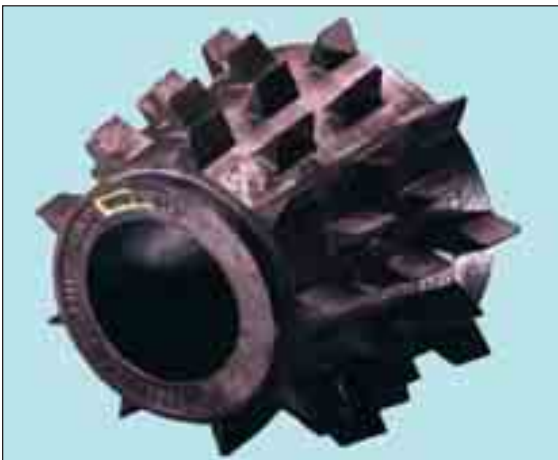
Gesteinsbohrkopf aus hoch verschleißbeständigem Vergütungsstahlguss, Masse 38 kg, Abmessungen Dmr. 350 x 250 mm
