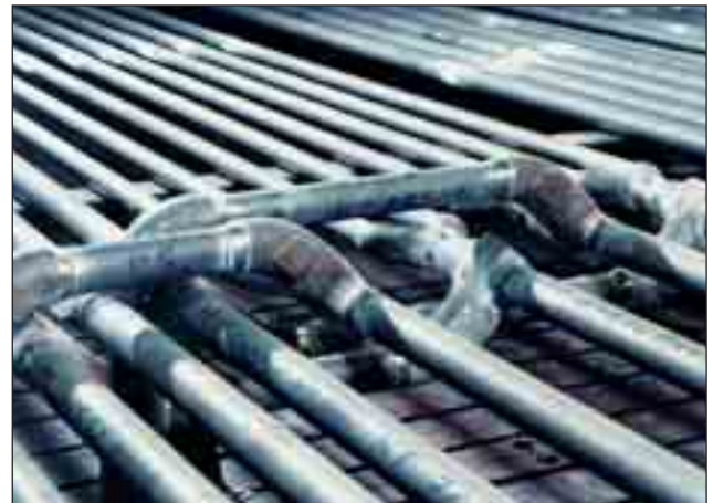
Coilsystem aus Form- und Schleuderguss, Werkstoff: GX40NiCrSiNb35-25
