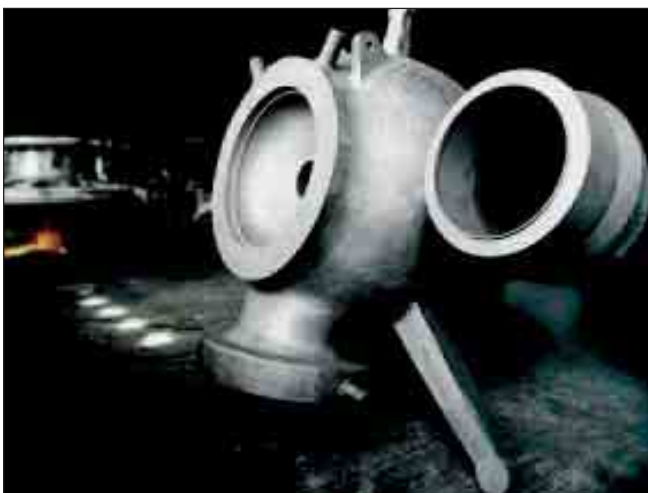
Bild 67: Ventilgehäuse aus GX12CrMoWVNbN10-1-1; Masse 27 t
