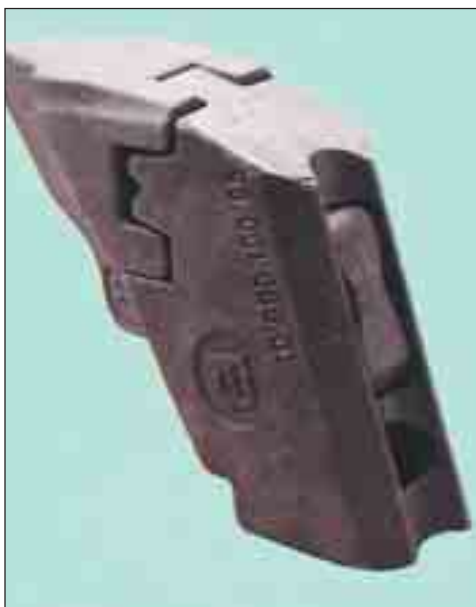
Bild 60: Einsatzfertig gegossener zweiteiliger Meißel mit Brecherkappe für einen Bergbauhobel aus dem Werkstoff G42CrMo4 bzw. G28Mn6; Masse 12 kg
