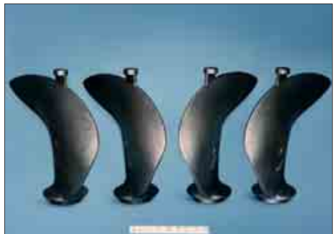
Bild 94: Nichtmagnetisierbare Propellerflügel für einen Schiffsantrieb aus GX2CrNiMnMoNNb21-16-5-3 der Abmessungen 800 x 900 mm; Masse pro Teil 150 kg
