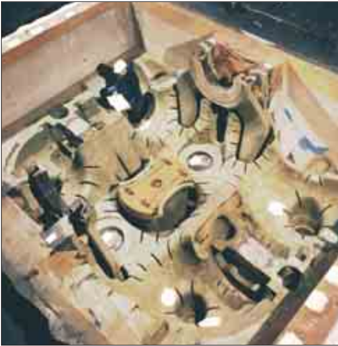
Bild 2: Komplexe Formhälfte mit diversen Kernen für ein großes Turbinengehäuse-Unterteil aus Stahl
