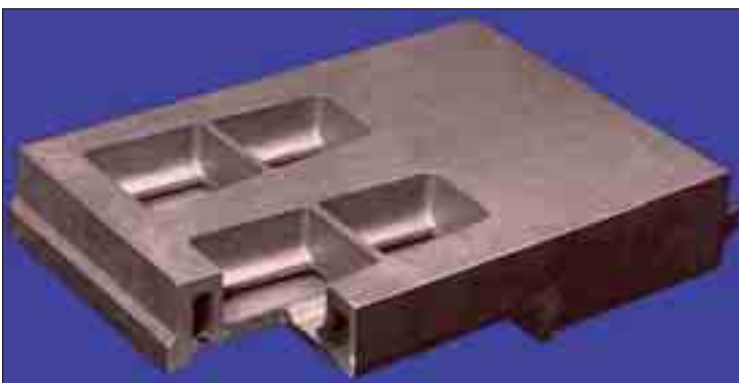
Bild 25: Einzeln belüftete Omega-Rostplatte für einen Klinkerkühler, Bauart Humboldt Wedag aus hitzebeständigem Stahlguss GX40CrNiSi25-12, einteiliges Gussteil mit komplexen eingegossenen Luftkanälen, Wanddicke 8 - 12 mm, Gewicht 23 kg
