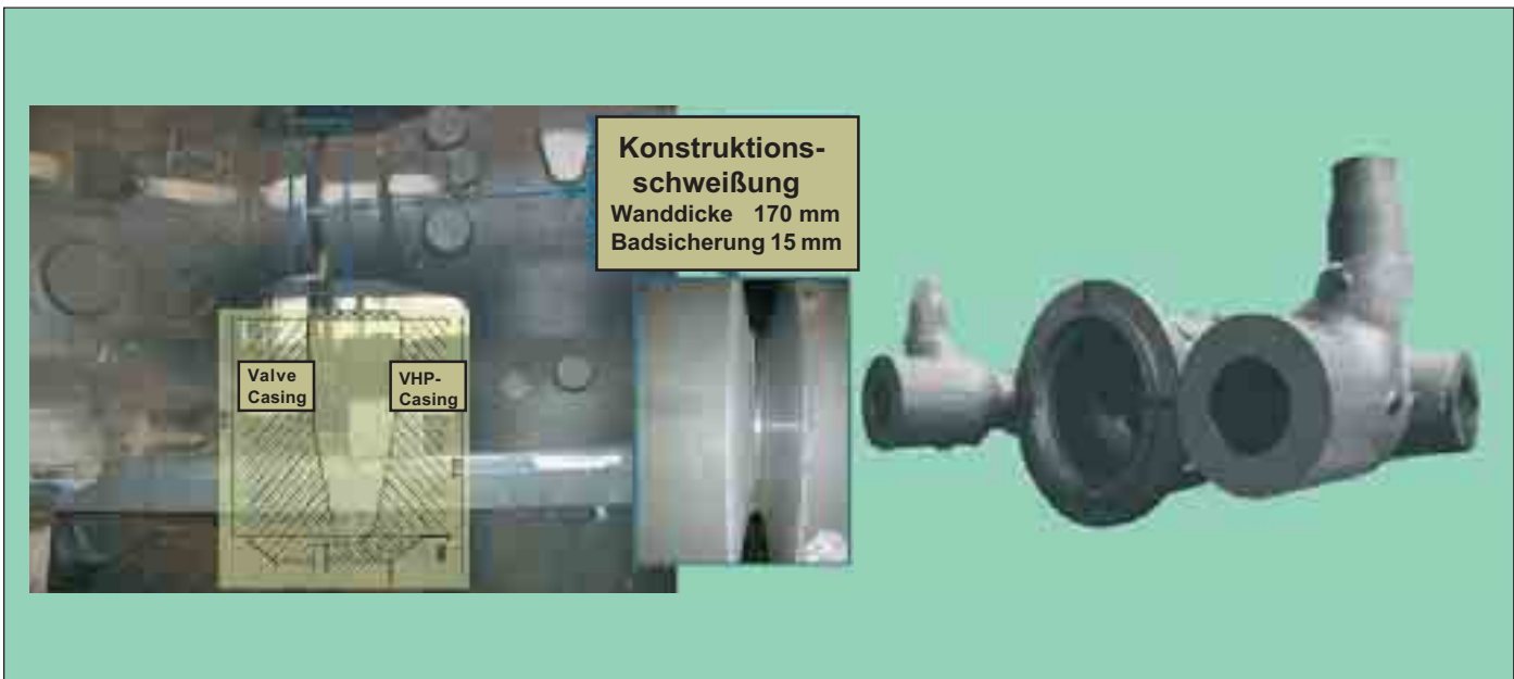
Bild 71: Außengehäuse für die Hochdruckstufe einer Turbine mit angeschweißten Ventilen aus GX12CrMoWVNbN10-1-1; Masse 31 t + 2 x 19 t = 69 t
