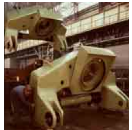
Schwinghebel für Mühlen aus GE240, Masse 13,1 t, Abmessungen 3,56 x 2,02 x 1,67 m
