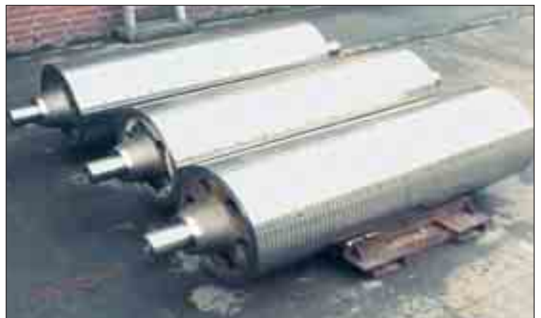
Umlenkrollen für Verzinkungsanlagen aus GX40CrNiSi22-9
