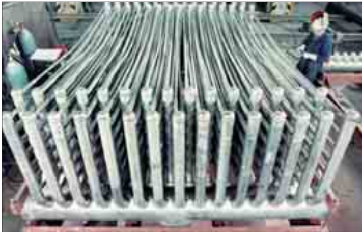
Ethylenofen mit Schleudergussteilen aus dem Werkstoff GX40NiCrSiNb35-25
