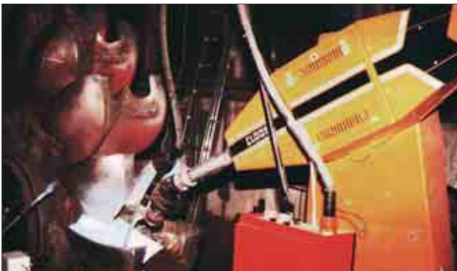
Bild 32: Einsatz eines Industrieroboters für das Schweißen einer Peltonsturbinen-Laufrades aus GX5CrNi13-4 nach dem MSG-Verfahren
