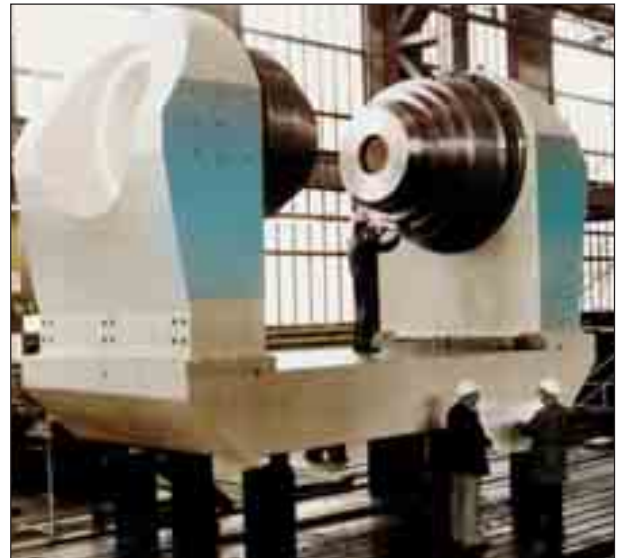
Bild 76: Mehrteiliges Magnet aus dem Kernforschungszentrum CERN aus einem weichmagnetischen Stahlguss mit einer Koerzitivfeldstärke von weniger als 100A/m; Masse 350 t
