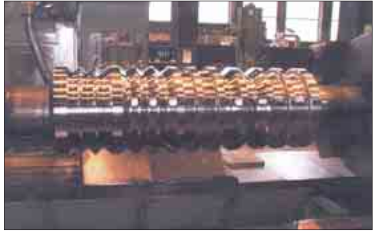
Gusswalzen aus unter- und übereutektoidem Stahlguss kommen in der Umformtechnik zum Einsatz
