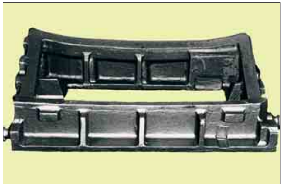
Bild 103: Drückrahmen aus GX165CrMoV12; Abmessungen 1700 x 900 x 400 mm
