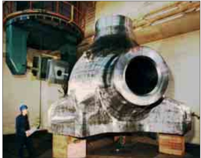
Bild 49: Durchstrahlungsprüfung eines Pumpengehäuses aus ASTM CF-3 für ein Kernkraftwerk mit Hilfe eines Linearbeschleunigers (Masse 32 t)
