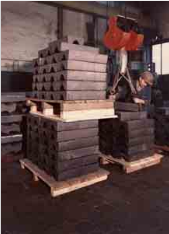
Bild 100: Schlagleisten aus verschleißbeständigem Chromhartguss; Stückmasse 104 kg
