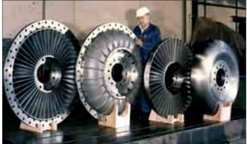
Laufräder für Flüssigkeitskupplung von Kernkraftwerken aus unlegiertem Baustahl E295 mit Massen von 690 bis 420 kg und Dmr. von 1162 bis 1372 mm
