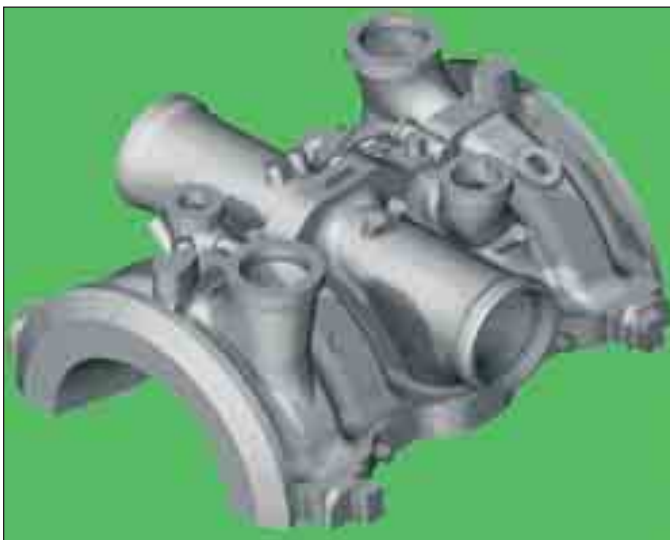
Bild 12: 3-D-CAD-Modell einer Innengehäusehälfte (60 t)
