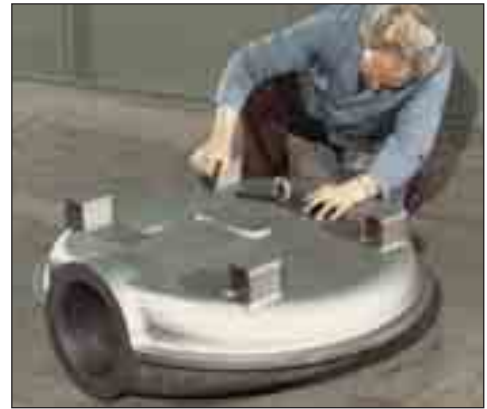
Absperrklappe für eine Dampfleitung aus warmfesten Vergütungsstahl der Abmessungen Dmr. 1080 x 340 mm, Masse 745 kg
