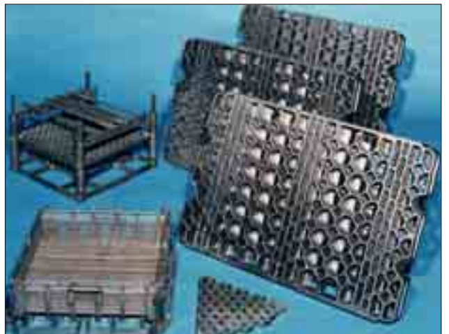
Chargiervorrichtung für Industrieöfen aus GX12NiCr36-18
