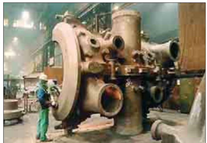
Bild 68: Innengehäuse für die Mitteldruckstufe einer Turbine aus GX12CrMoWVNbN10-1-1; Masse 60 t
