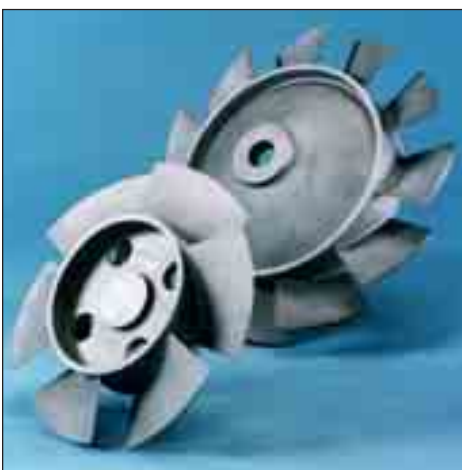
Lüfterräder für Großmotoren aus Stahlfeinguss, Werkstoff GX5CrNiMo16-5, Masse etwa 14 kg (links)
