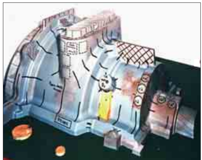
Bild 11: Holzmodell für ein Dampfturbinengehäuse mit eingezeichneter Gießtechnik
