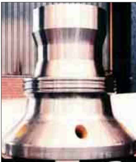
Bild 58: Schlaghaube aus GX5CrNi13-4 zum Einrammen von Rohren; Masse 28 t
