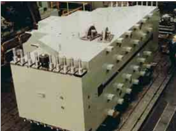
Bild 75: Ein Teil eines zweiteiligen Hochleistungsmagneten aus weichmagnetischem Stahlguss mit weniger als 0,01 % C-Gehalt; Masse 420 t
