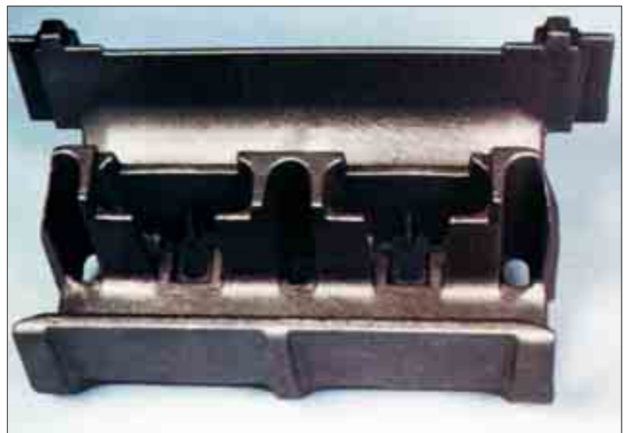
Bild 61: Lager- und Schutzhaube für die Transportkette eines Bergbauförderers aus G42CrMo4; Abmessungen 740 x 480 x 340 mm; Masse 265 kg
