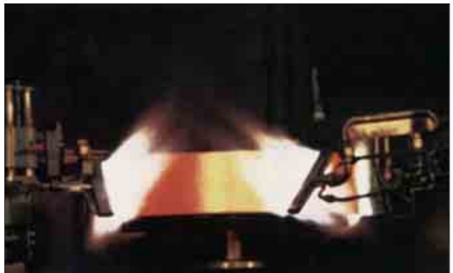
Bild 102: Flammhärten eines Stahlguss-Laufrades für einen Kran
