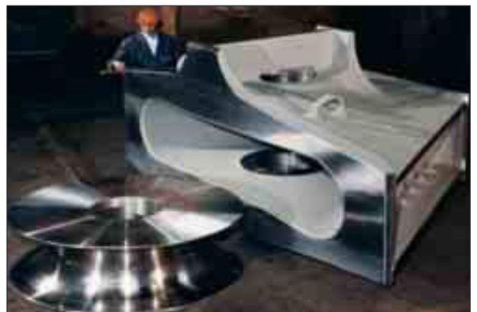
Hebeknoten und zugehörige Seilumlenscheibe für eine Ölförderplattform aus G32NiCrMo8-4-6, Gesamtmasse 140 kg
