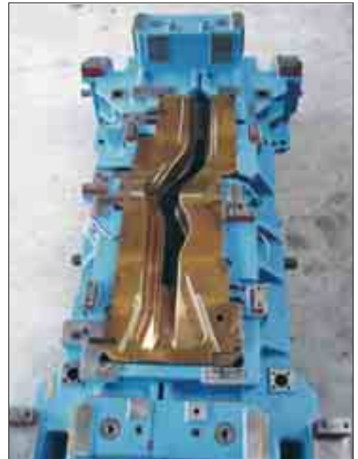
Bild 105: Ziehmatrize mit Segmenten aus GX155CrMo12-1 (1.2382), CVD-beschichtet, Härte 58 - 60 HRC
