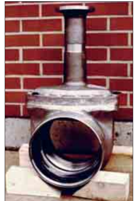
Bild 74: DN-12"-Absperргеhäuse aus kaltzähem Stahlguss nach ASTM A 351 CF 8 M für flüssige Gase bis -196 °C; Masse 140 kg
