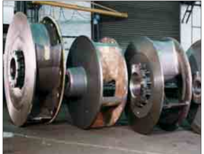
Laufräder aus hoch verschleißbeständigem Stahlguss für Nassbaggerpumpen mit bis 1750 mm Dmr.
