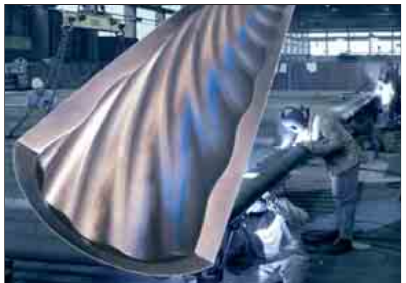
Innenprofiliertes Schleudergussrohr für den Einsatz in Streamcrackern aus GX40NiCrSiNb35-25
