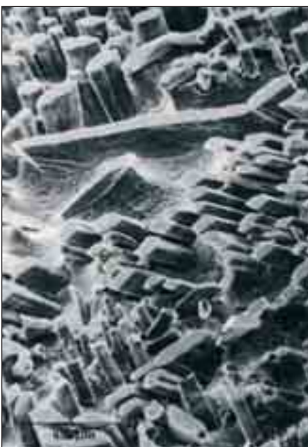
Bild 44: REM-Aufnahme der tiefgeätzten Oberfläche eines ferritisch-austenitischen Duplex-Stahlgusses [12]
