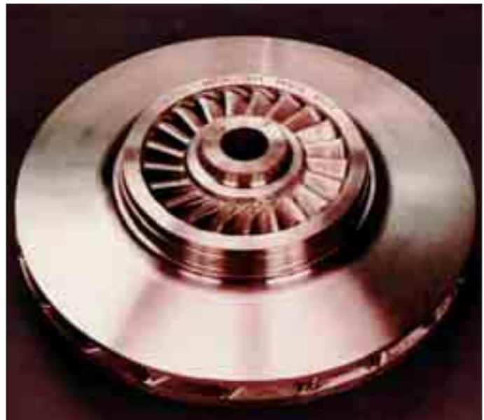
Bild 78: Laufrad aus GX5CrNi13-4 für einen Radialverdichter mit einem Durchmesser von 1,2 m
