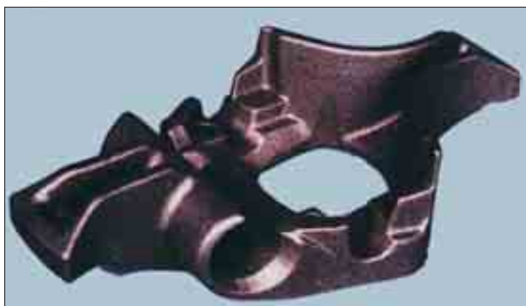
Bild 56: Hochbeanspruchtes Bauteil für einen Förderer im Bergbau zum Transport und zur Gewinnung von Kohle aus G22NiMoCr5-6; Abmessungen 710 x 380 x 160 mm; Masse 66 kg
