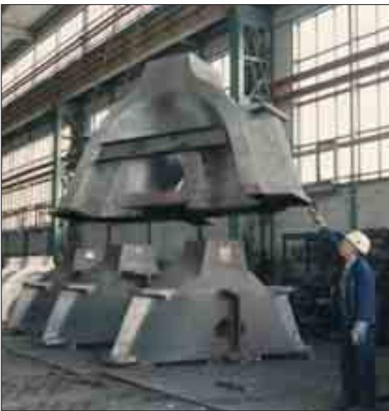
Komponenten für den Bau von Offshore-Plattformen aus G13MnNi6-4 im Massebereich von 10,5 bis 12,4 t (links)
