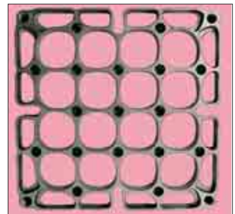
Bild 92: Rost für einen Durchstoß-Glühofen, der je nach Beanspruchung aus einer hierfür geeigneten hitzebeständigen Stahlgussorte gegossen wird; Abmessungen 580 x 580 mm
