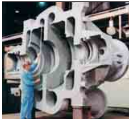
Bild 55: Gehäuseunterteil für den Niederdruckteil eines zweistufigen Turbokompressors zur Verdichtung von Rohgas aus dem Werkstoff GE380; Masse 36 t
