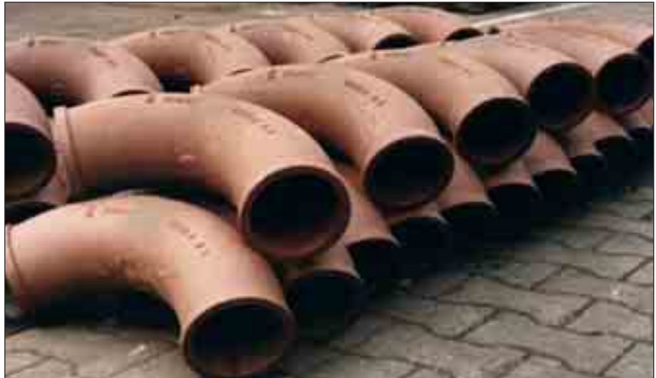
Bild 98: Einbaufertig gegossene Rohrbögen (Maskenformguss) zur Förderung von Beton aus GX120MnCr13-2 der Baugröße DN 100; Stückmasse 12,4 kg
