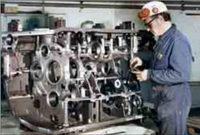
Getriebegehäuse, aus mehreren Stahlgussstücken zusammen geschweißt, aus G20Mn5
