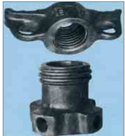
Bild 54: Einschließlich der Gewinde Rd 90 x 10 einbaufertig aus GE260 gegossene Traverse und Spannmutter für ein Transportgeschirr
