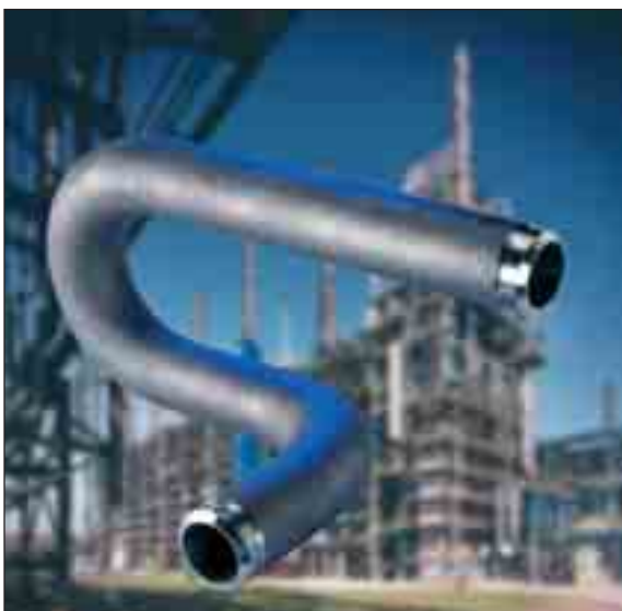
Gebogenes Schleudergussrohr für Streamcracker aus GX40NiCrSiNb35-25
