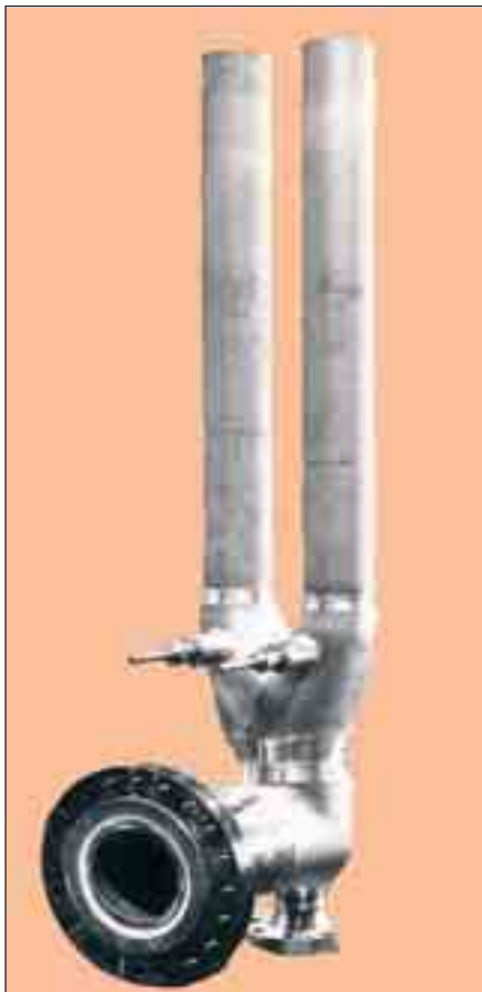
Bild 91: Austrittsrohr für einen Ethylenofen in Gussverbundkonstruktion bestehend aus Form- und Schleudergussteilen aus verschiedenen hitzebeständigen austenitischen Stahlgussorten; Höhe 2,6 m
