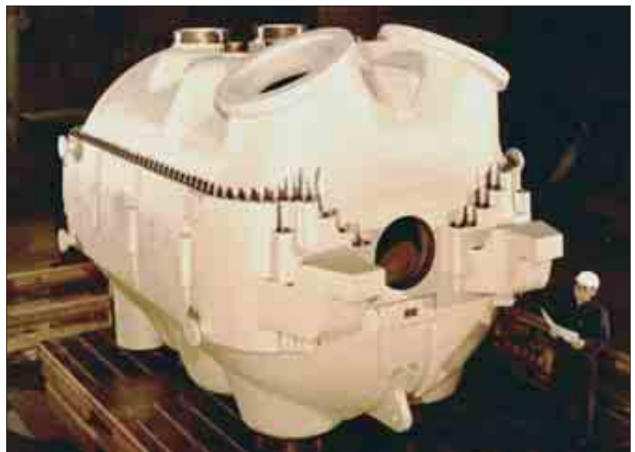
Bild 63: Außengehäuse aus G17CrMo5-5 für eine Dampfturbine, Masse 80 t
