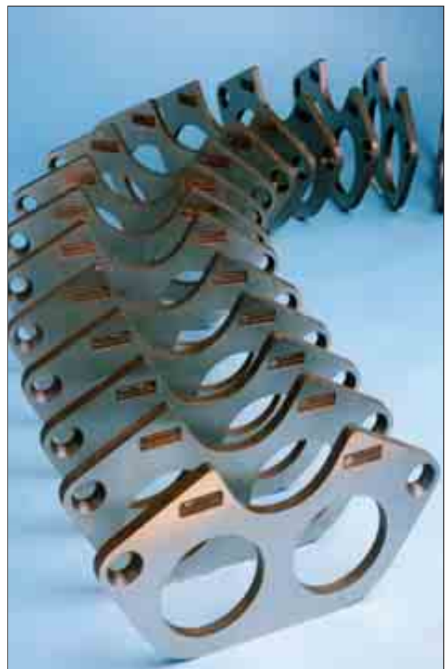
Gehäuseauskleidung für Betonmischer aus GX180CrMoCo14-1-1, Masse 15 kg (oben)
