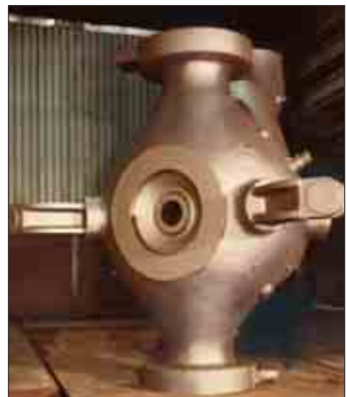
Ventilgehäuse für Dampfturbine aus G17CrMoV5-11, Masse 14,2 t
