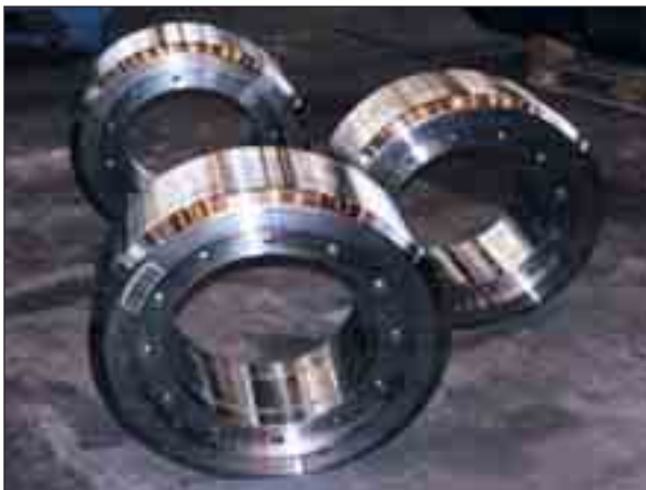
Walzenringe aus perlitischem Stahlguss erzielen durch eingelagerte Carbide hohe Festigkeitswerte
