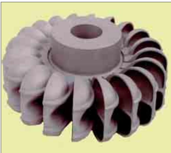
Bild 77: Peltonrad im Keramikformverfahren gefertigt aus GX5CrNi13-4 mit einem Durchmesser von 845 x 210 mm
