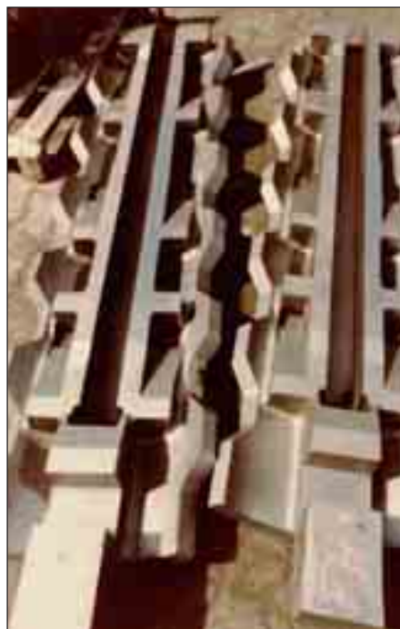
Bild 65: Haspelsegmente aus GX23CrMoV12-1 für eine Warmbreitbandstraße, 2350 mm lang
