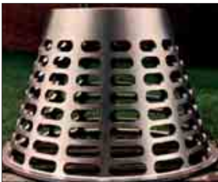
Zentrifugentrommel aus GX2CrNiMoN17-13-4, Masse 500 kg
