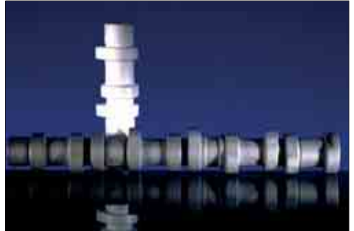
Im Lost-Foam-Verfahren gefertigte hohl gegossene Nockenwelle mit reduzierter Wanddicke aus G100Cr6, Masse 2,1 kg, Dmr. 50 x 360 mm
