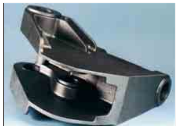
Bild 57: Lenker für eine Baggerschaufel aus dem Werkstoff G32NiCrMo6-4; Abmessungen 630 x 620 x 360 mm; Masse 165 kg
