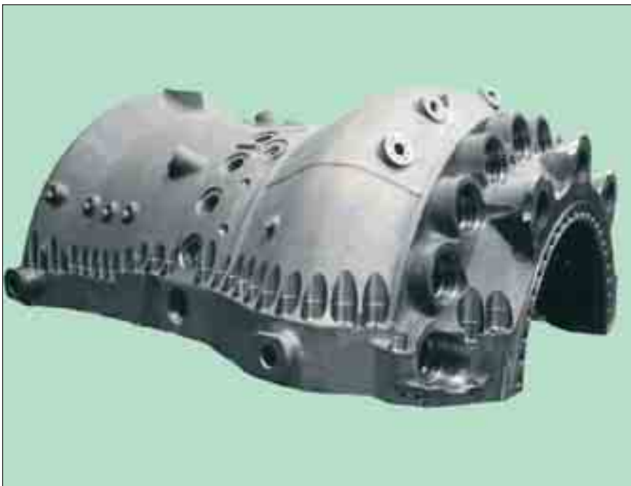
Bild 72: Gasturbinengehäuse aus G17CrMo5-5; Masse 27 t
