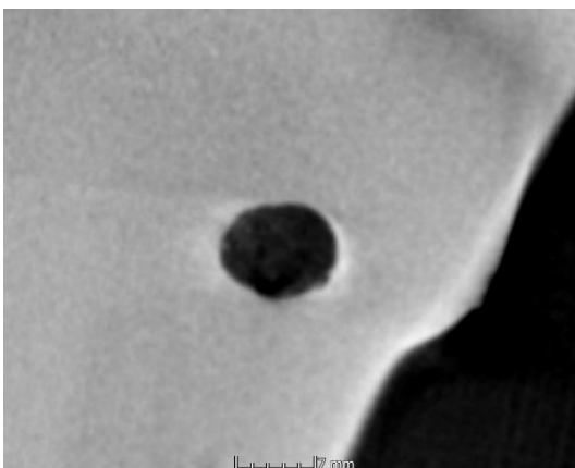
Bild 4a: Ausprägung von Gasporosität, CT-Schnittbild
