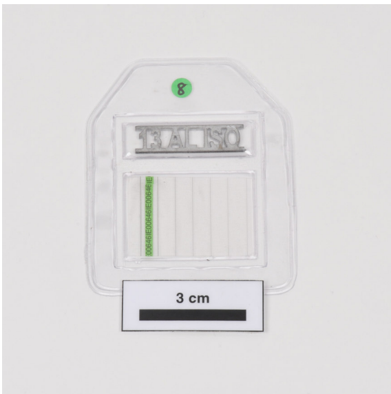
Bild 35: Bildgüteprüfkörper nach ISO 19232-1 (Drahtsteg) für die Kontrastbestimmung nach EN 12681-2 (in diesem Fall für Aluminium); links: Abbildung; rechts: CT-Schnittbild
