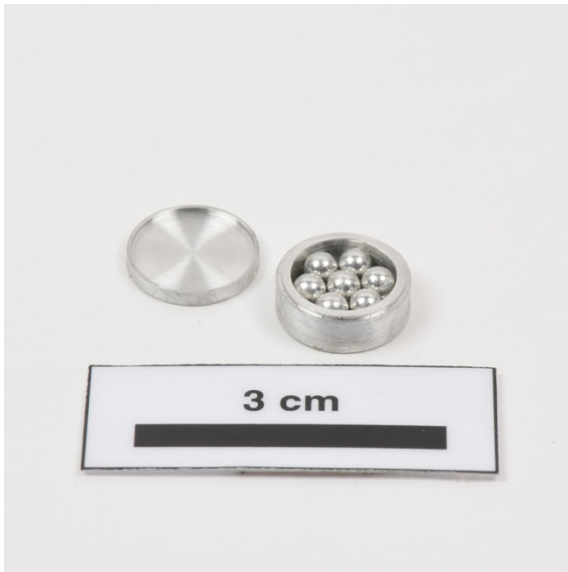
Bild 38: Kugelprüfkörper mit 7 Al-Kugeln eingebracht in einem Al-Hohlzylinder. Über das bekannte Innenvolumen der Luft kann auf einen (globalen) Schwellwert für die Porositätsanalyse in einem Al-Gussteil rückgerechnet werden; links: Abbildung; rechts: CT-Schnittbild
