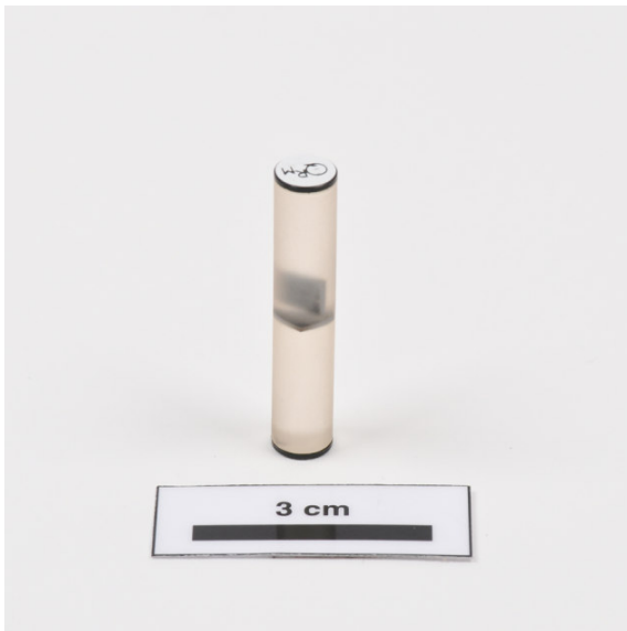
Bild 34: Linienraster auf Siliziumplättchen in Gießharz für die Auflösungsbestimmungen in axialer und frontaler Ansicht mit Linienstärken von 5 bis 150 \mu\text{m} ; links: Abbildung; rechts: CT-Schnittbild
