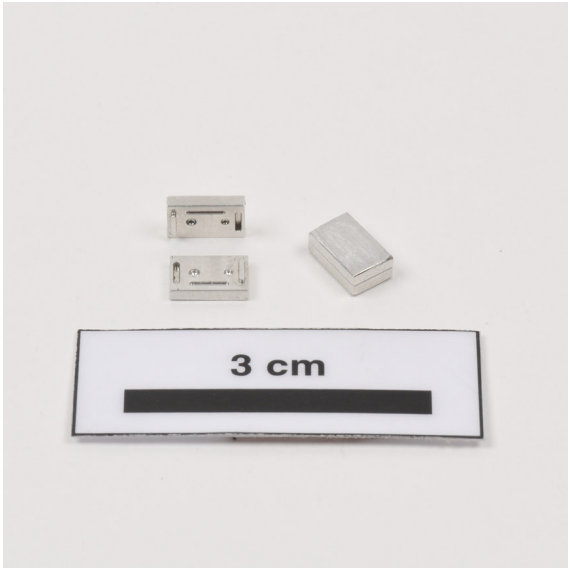
Bild 37: Matrize mit eingefrästen kugelförmigen Hohlräumen mit 0,8 und 1 mm Durchmesser zum Vergleich mit tatsächlich gefundenen Porositäten; links: Abbildung; rechts: CT-Schnittbild
