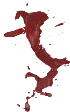
Bild 2b: Schwindungsporosität, 3D-Visualisierung
