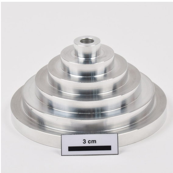
Bild 39: Stufenhohlzylinder aus Aluminium mit Durchmessern von 20 bis 120 mm und einer Bohrung von 10 mm. Über die Erkennbarkeit (bzw. über die Bestimmung des CNR) der Bohrung kann auf die Kontrasteigenschaften eines CT-Scans bei bestimmten CT-Parametern in Abhängigkeit der durchstrahlten Wandstärken rückgeschlossen werden; links: Abbildung; rechts: CT-Schnittbild
